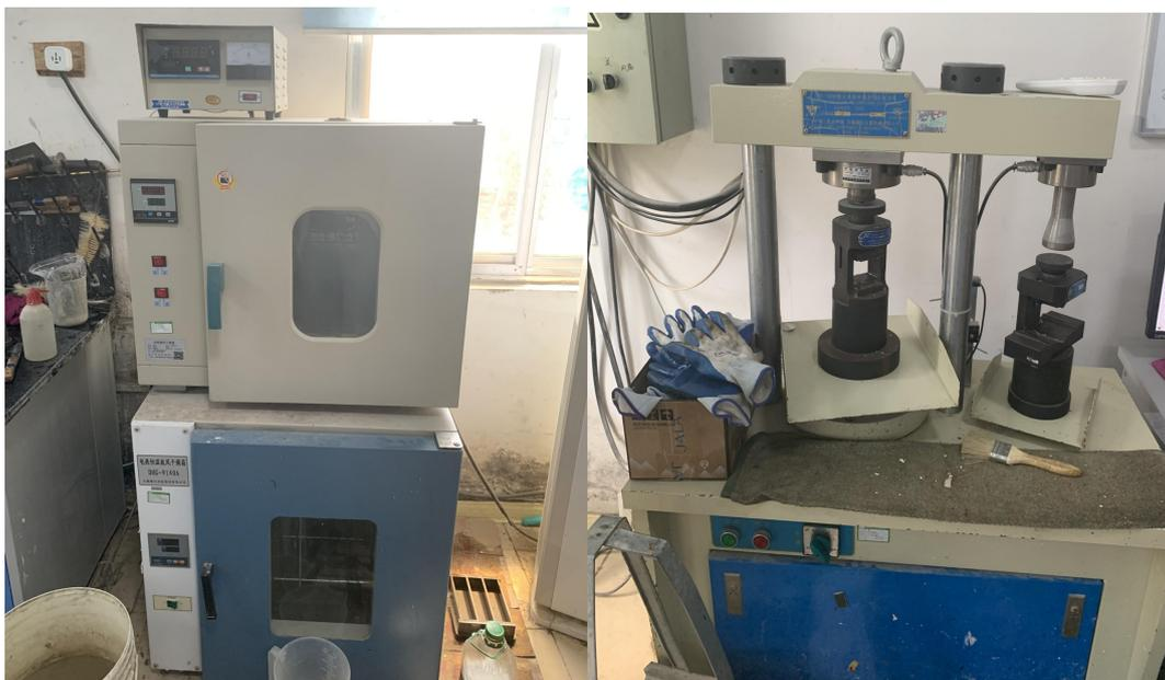
图 5-2 电热恒温鼓风干燥箱与抗折抗压试验机
