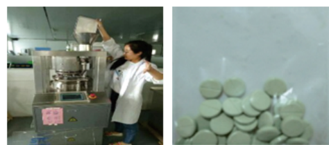
粉末直接压片技术比湿法制粒压片法工艺简化
