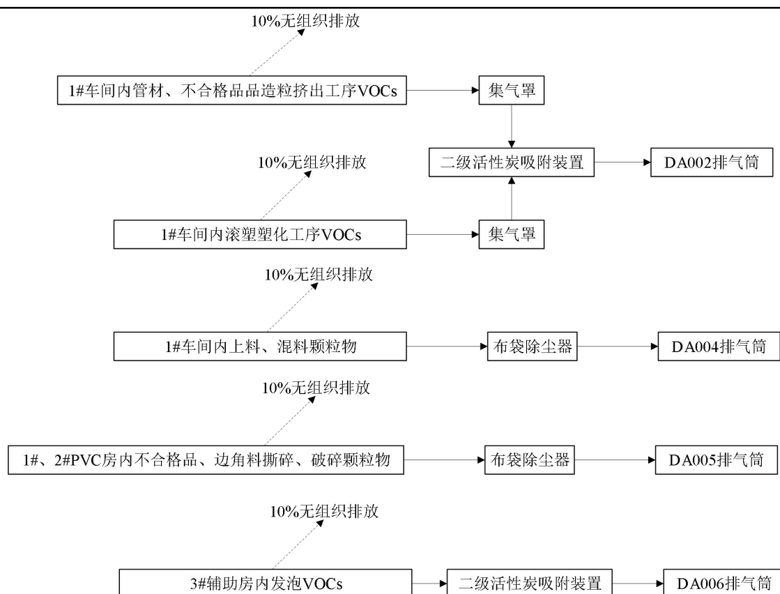
图 4-1 废气收集处置情况示意图
