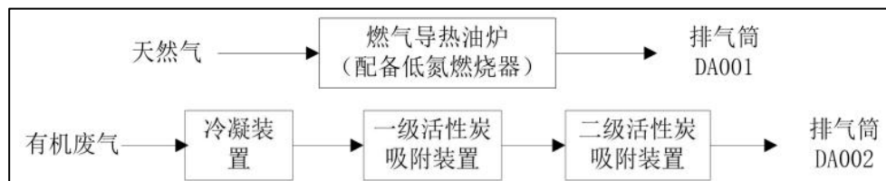
图 2-6 现有建工程废气处理工艺流程图
