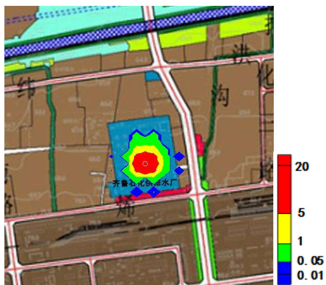
图 5.2.3-84 60d 后石油类在地下水中污染范围示意图
