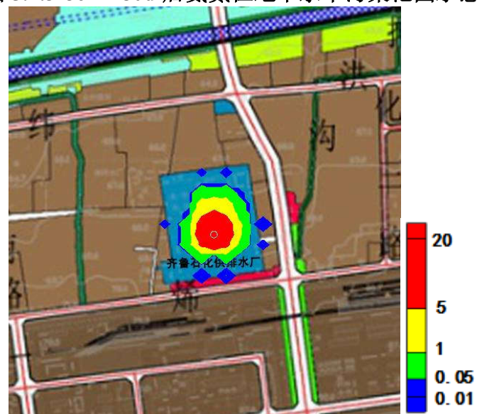
图 5.2.3-87 180d 后石油类在地下水中污染范围示意图
