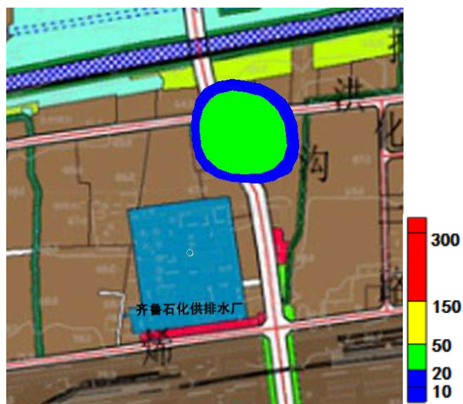
图 5.2.3-75 3600d 后 COD 在地下水中污染范围示意图
