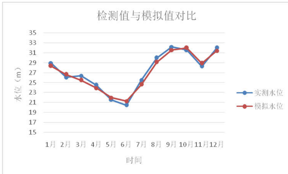
图 5.2.3-16 模型拟合期湖田观测井水位观测值及计算值对比
